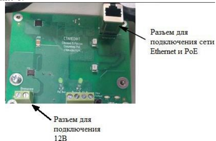
Рисунок 1 – Подключение IP-видеокамеры
